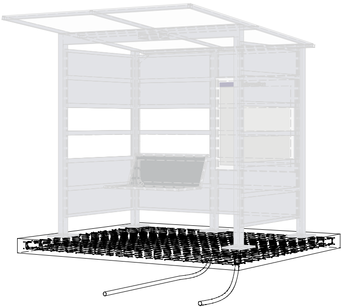
Perspektive Fundamentplatte, WSH-Darstellung nur informativ (unmaßstäblich)
